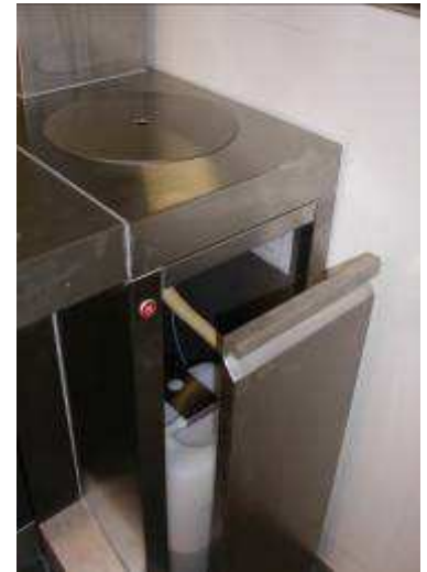
Figure 16- table de macroscopie avec double aspiration (basse et frontale à l'arrière du plan de travail), écrans de protection et vidoir formol
